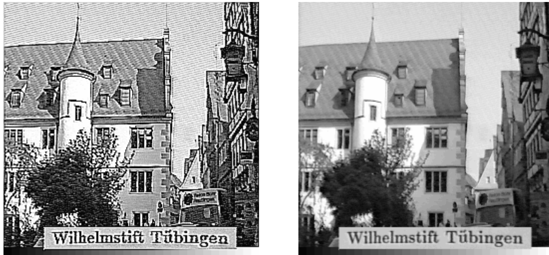
Abbildung 7.3: Ein dem Originalbild in der Frequenz und der Amplitude überlagertes periodisches Störsignal (Brummen; links) kann durch die Filterung mit dem entsprechenden inversen Störsignal relativ gut restauriert werden (rechts).
